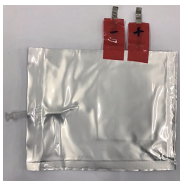
图2 软包电池在线采气装置
