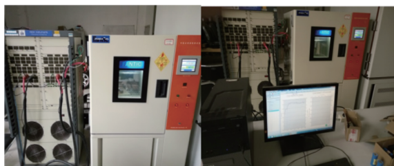
图2 锂离子电池充放电测试平台
