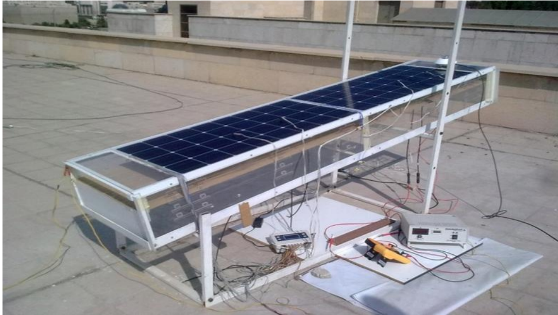
图 4. 混合光伏/T 集热器实验装置
