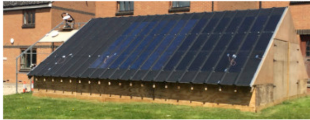
图 13. 太阳能混合 PV/T 测试安装视图
